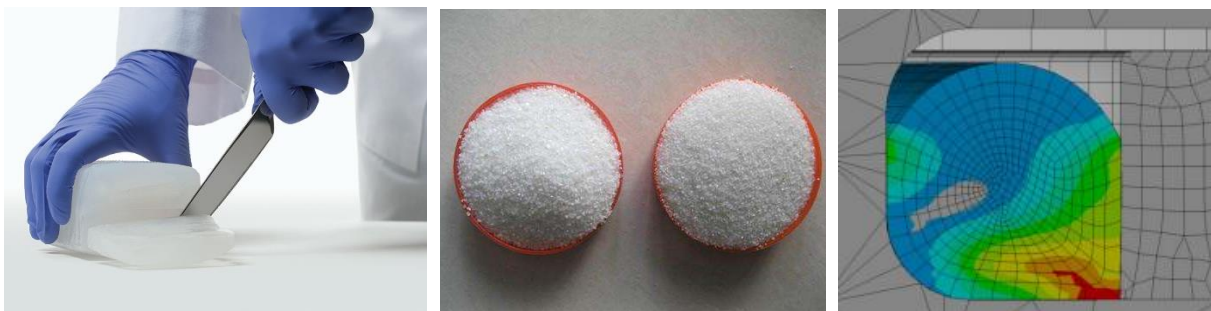
Abbildung: Polydimethylsiloxan roh (links), pyrogene Silica-Partikel (mitte) und FEM-Simulation eines O-Rings aus Silikon (rechts)
