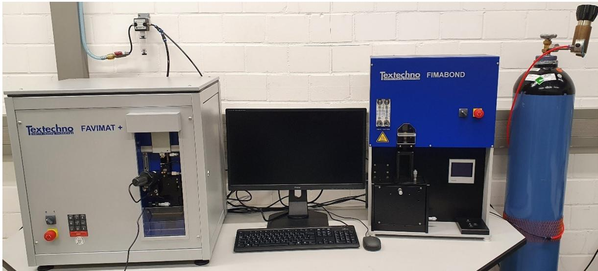
Abbildung 4: Einzelfaserprüfgerät FIMATEST am Institut für Werkstofftechnik
