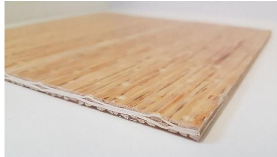
Abbildung 2: Weidengewebeverstärkter Kunststoff
