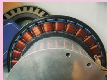
Abbildung 1: Vergussbauteil mit Silikonkautschuk
