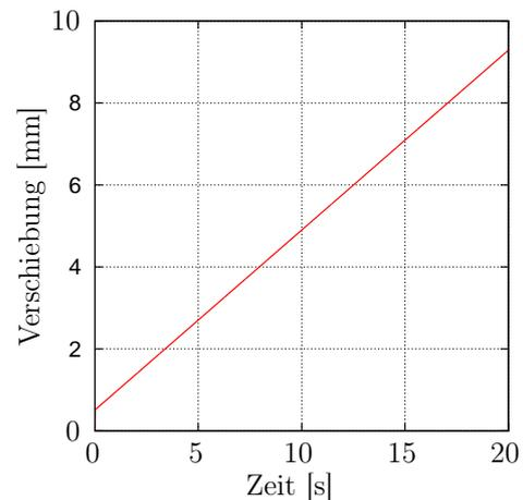
Abb. 5: Verschiebungsverlauf (Kriechkurve) über der Zeit
