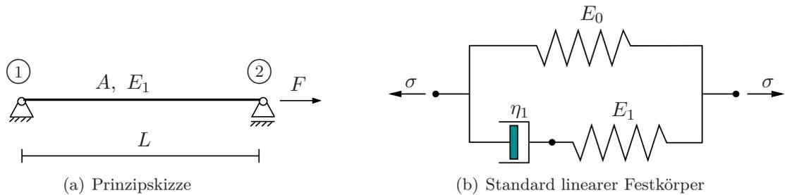
**Abb. 1:** FE-Modell und rheologisches Modell des standard linearen Festkörpers vom MAXWELL-Typ
