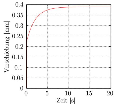
Abb. 3: Verschiebungsverlauf (Kriechkurve) über der Zeit
