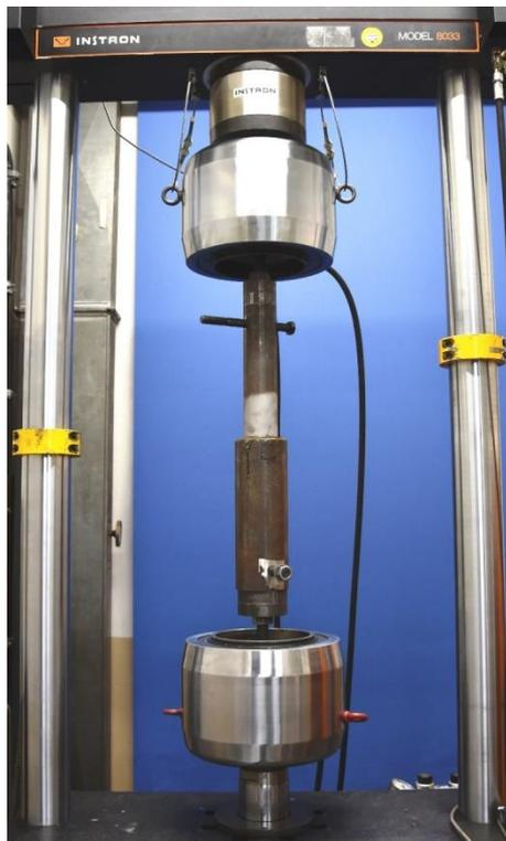
Abbildung 4: Versuchsaufbau der dynamischen Hystereseversuche unter harmonischer Fremdanregung
