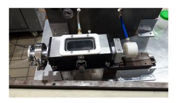
In einem ersten Schritt soll die Adaption der Emissionskammer an den Extruder optimiert werden. Danach soll die Charakterisierung der Emissionen und des Geruchs an Standardkunststoffen und Compounden erfolgen. Weitere Untersuchungen, wie z.B. Thermische Analyse, Lösungsmittelviskosität und mikroskopische Untersuchungen, die Auskunft über den Zustand des Materials in den verschiedenen Verarbeitungsstufen geben, sollen ergänzend durchgeführt werden.
