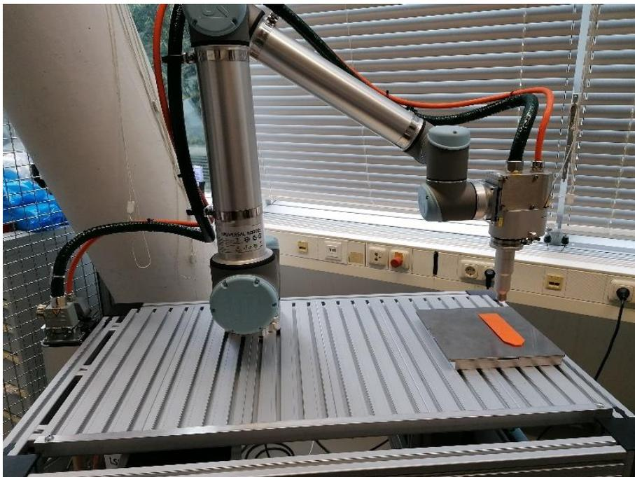
**Abbildung 4: Plasmaanlage der Firma Plasmatrete GmbH**
