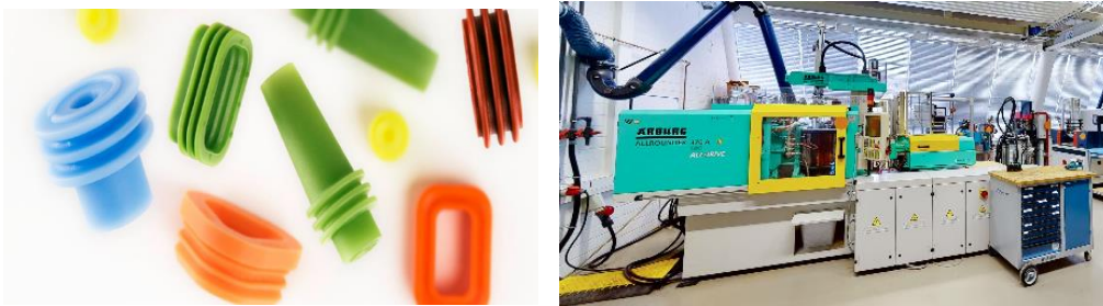
Dichtungen aus Silikon (links), LSR-Spritzgießmaschine (rechts)
