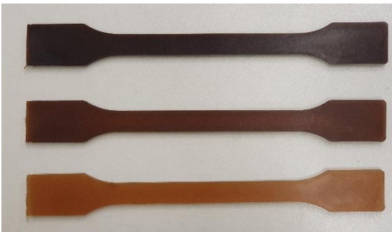
Abb. 2 Schulterstäbe mit steigendem Fasergehalt (10, 20, 30 % v. u. n. o.)
