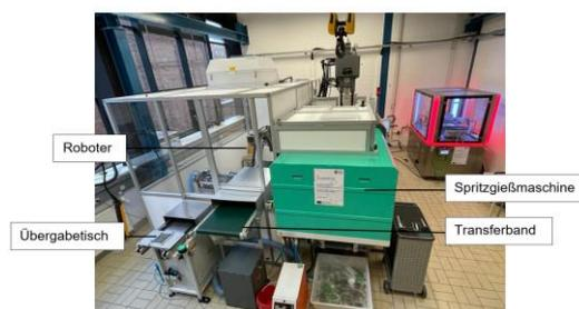
Abbildung 12: Seriennahe halbautomatische Fertigungszelle zum Hinterspritzen einer EC-Folie mit Roboterhandlung und Säuberung der Folie
