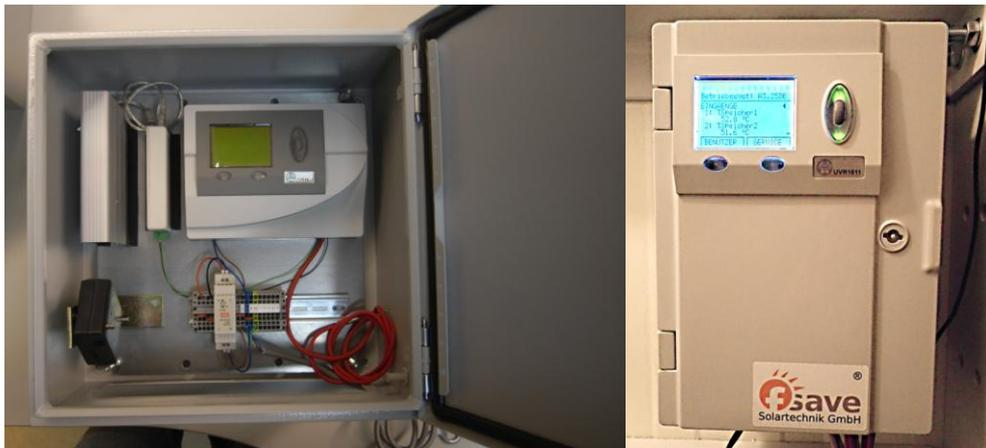
*Abbildung 6: Prototyp der Mess-, Regel- und Überwachungs-Einheit*
