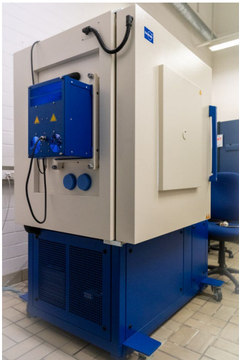
Feutron Klimaschrank KPK 200 (links) und künstliche Bewitterung von Prüfkörpern (rechts)
