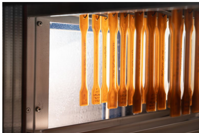
Feutron Klimaschrank KPK 200 (links) und künstliche Bewitterung von Prüfkörpern (rechts)
