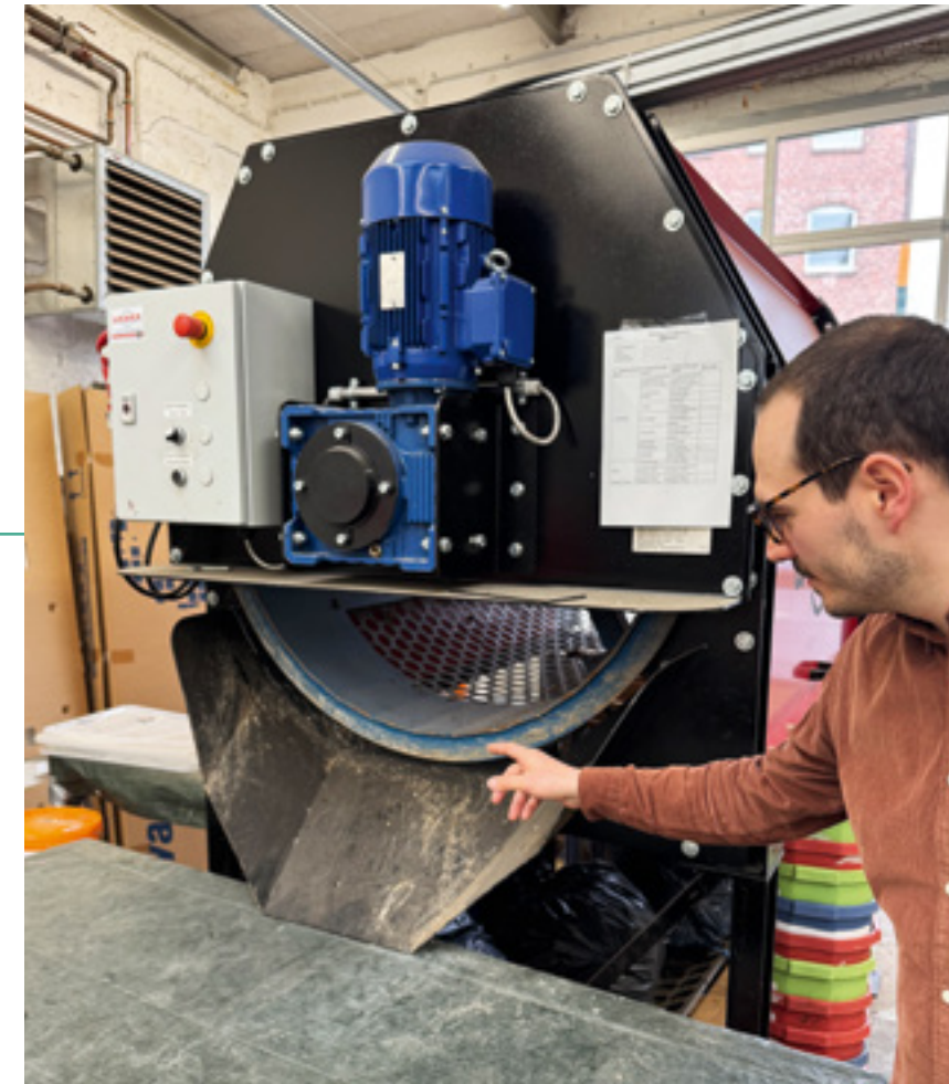
Dem Abfall auf der Spur: Konstantin Bachmann an der Siebtrommel in der Laborhalle. Hier analysieren er und sein Team die Zusammensetzung des Biomülls, um den Anteil an Fremdstoffen zu bestimmen und die Qualität der Sammlung zu bewerten.
