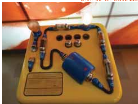
Bild 6: Versuchsaufbau zum Erfahren des Ohm'schen Gesetzes.
