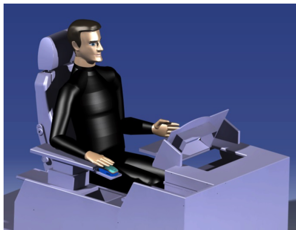
Abbildung 4.35: CAD-Rendering der Höhen- und längsverstellbaren Armlehne beim 95. Perzentil männlich
