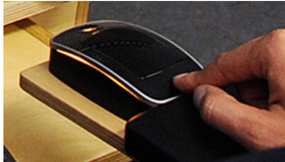
Abbildung 4.34: Kapazitives Touchpad mit elektromechanischer haptischer Rückmeldung
