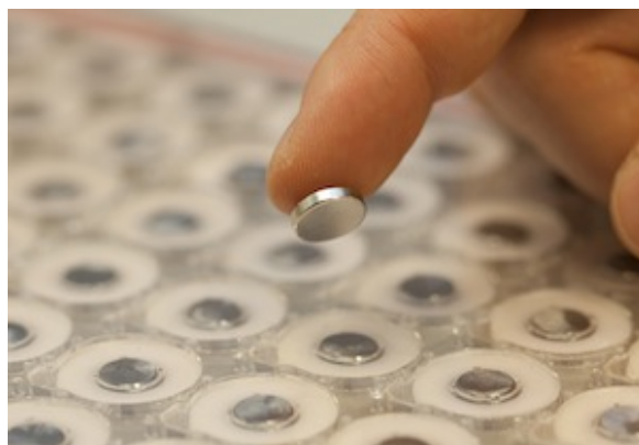
Abbildung 3.21: Spulenmatrix und Permanentmagnet der magnetischen Rückmeldung (Weiss et al. 2011, S. 615)
