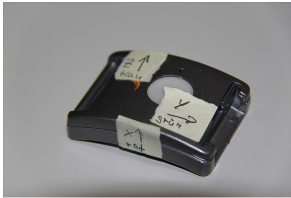
Abbildung 4.12: Beschleunigungssensor vom Typ Affectiva Q-Sensor 2.0 mit Markierungen für die Orientierung der drei Raumachsen
