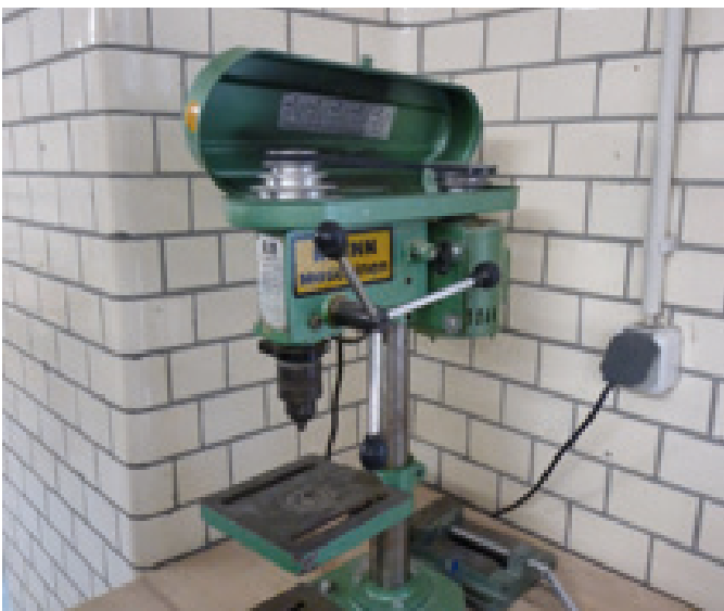
Abb. 14: Riemenabdeckung lässt sich ohne Werkzeug öffnen, Not-Aus-Schalter fehlt
