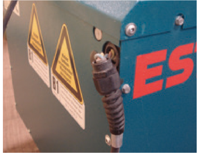
Abb. 19: Kabelzuführung an einem Schweißtrafo defekt
