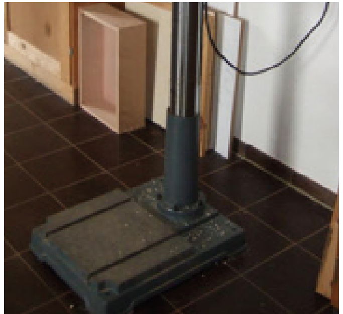
Abb. 16: Bohrmaschine nicht am Boden befestigt
