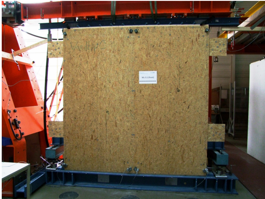
Abbildung 5.10: Versuchsaufbau bei symmetrischer Verankerung
