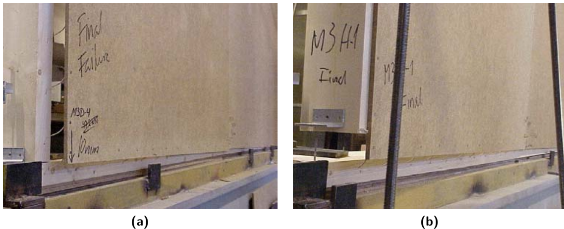
Abbildung 4.23: Auflagersituation und Versagensmechanismen bei Versuchen an Holzrahmenwänden; (a) Verankerung der Stiele (realisiert durch Auflast), (b) Verankerung der Schwelle, aus [Gir04a]
