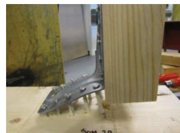
(f) Herausziehen Schrauben (Schwelle)
