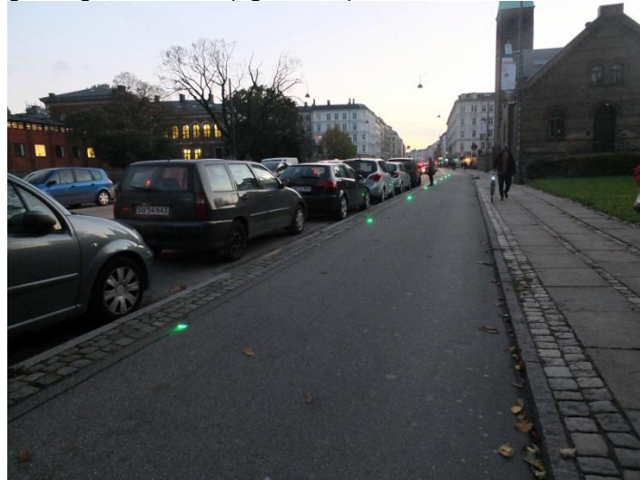
Abbildung 111: LED-Lichter zur Signalisierung der "Grünen Welle"
