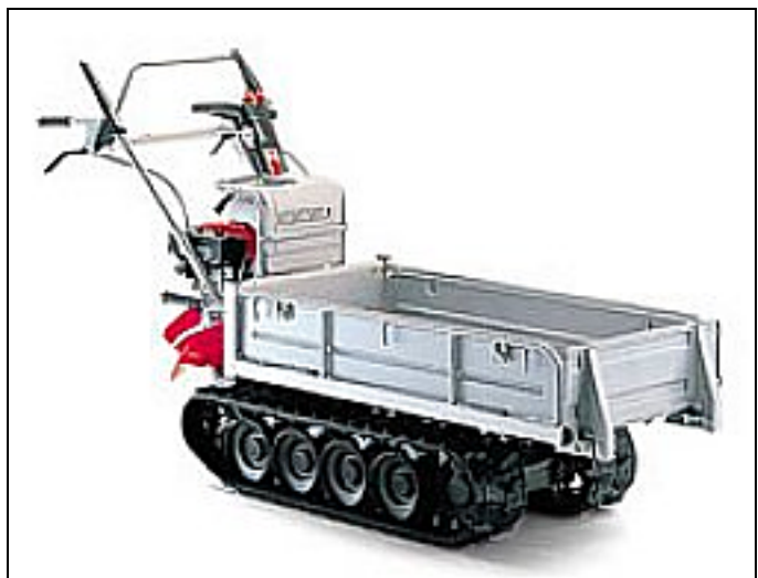
Abb. VIII/10: Handgeführte Transportraupe der Marke „HONDA“ mit abklappbarer Ladefläche. Der Antrieb erfolgt über einen Zahnkranz.
