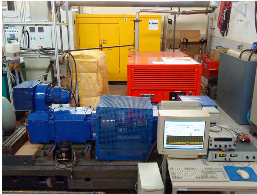
Abbildung 7.5: 80 kVA Synchrongeneratorsatz (vorn), 20 kVA stromrichtergekoppeltes Aggregat (Mitte) und 200 kVA Biodieselerzeuger (hinten)
