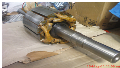
(D) New re-wound SNSP rotor of the prototype
