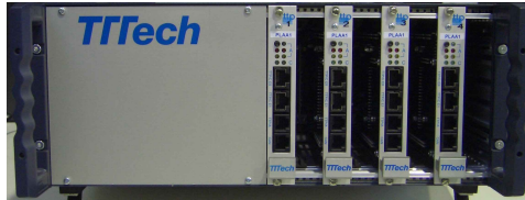
Bild 6.5: Rechencluster mit Flexrayschnittstelle
