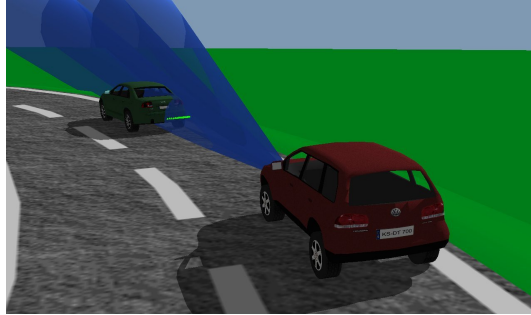
Bild 3.18: Radardaten in der Simulationsumgebung
