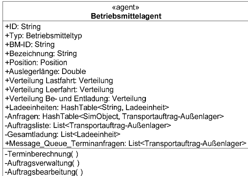
Abbildung 5.29: Klassendiagramm des Betriebsmittelagenten
