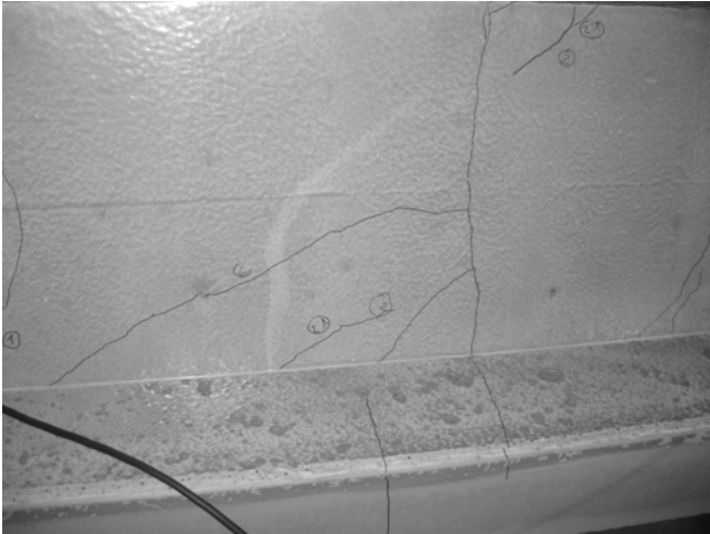
Bild 11: Schubrisse beginnen am Schwindriss
