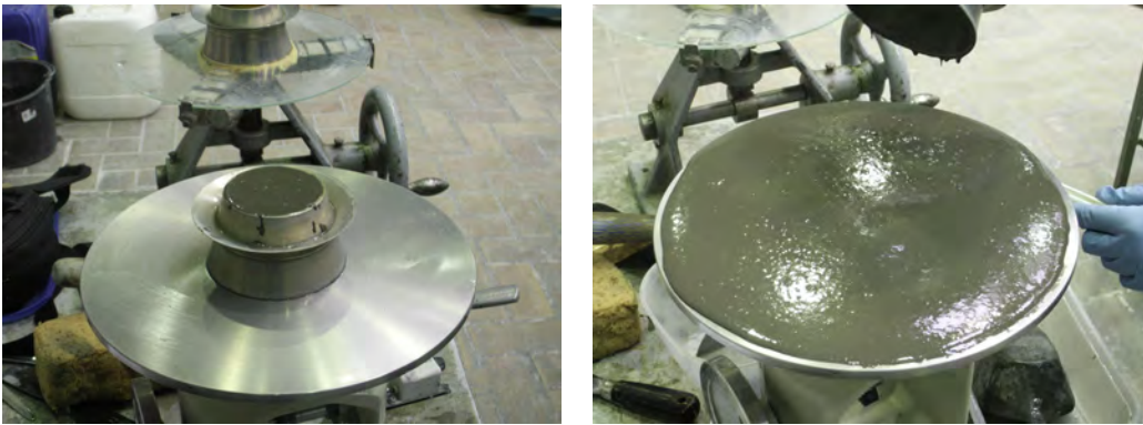
Bild 1: Ausbreitmaß nach DIN EN 1015-03 an dem Leim einer grobkörnigen UHPC-Rezeptur
