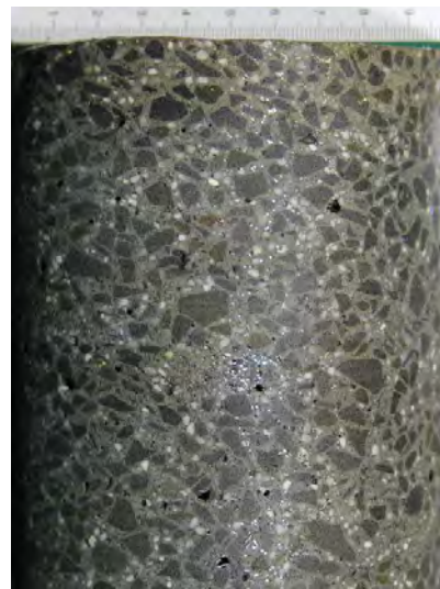
Bild 6: Links: Einbau einer 10 cm dicken Schicht aus UHPC mittels konventionellem Gleitschalungsfertiger; Rechts: aus der Fläche entnommener Bohrkern
