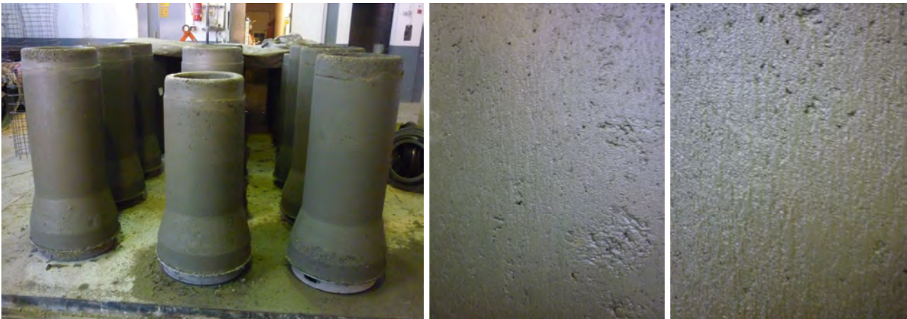
Bild 7: Hergestellte Betonrohre (links) in der Ansicht, Detail der Oberflächenstruktur UHPC-Rohr (mitte), Originalrohr Betonwerk (rechts)
