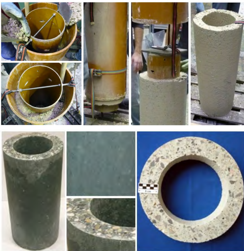
Bild 5: Herstellungsprozess des Rohr-Prototyps im Labormaßstab
