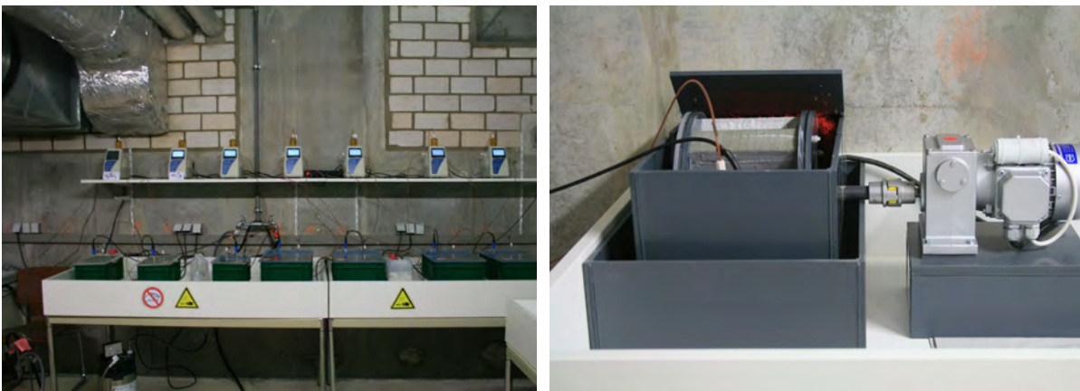
Bild 9: Aufbau des Säureprüfstandes als Multitasking Titrationssystem (links), Prüfeinrichtung kombiniert chemisch-mechanisches Prüfverfahren (rechts)
