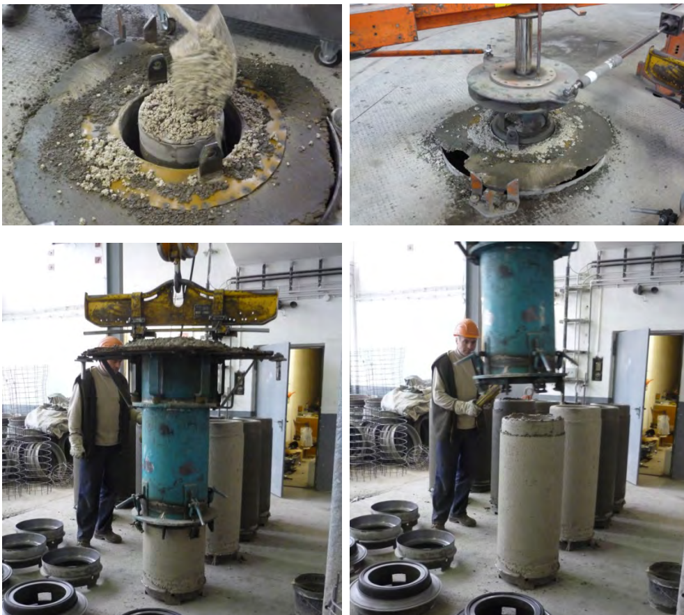
Bild 6: Fertigungsprozess eines Rohres aus Beton mit alkalisch aktiviertem Bindemittel im Werk
