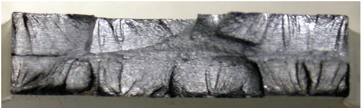
Abb. 6.60: Übersichtsaufnahme von der Bruchfläche; Probe mit gefräster Randschicht aus Knetlegierung AlZn4,5Mg1; Versuch im SSN mit \sigma_a = 270 MPa; Deutlich ist zu erkennen, dass es auf beiden Seiten mehrere Anrisse gab.
