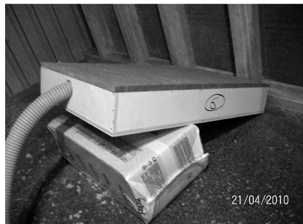
Abbildung 26: Einblasen des Altpapierdämmstoffs im Versuchsmodell
