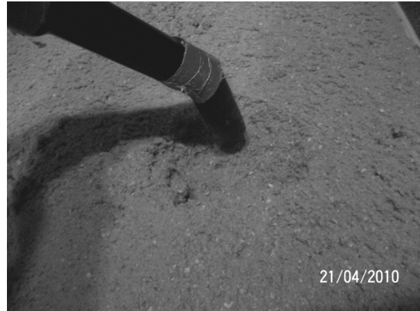
Abbildung 29: Entnehmen der Saugprobe mit Staubsauger
