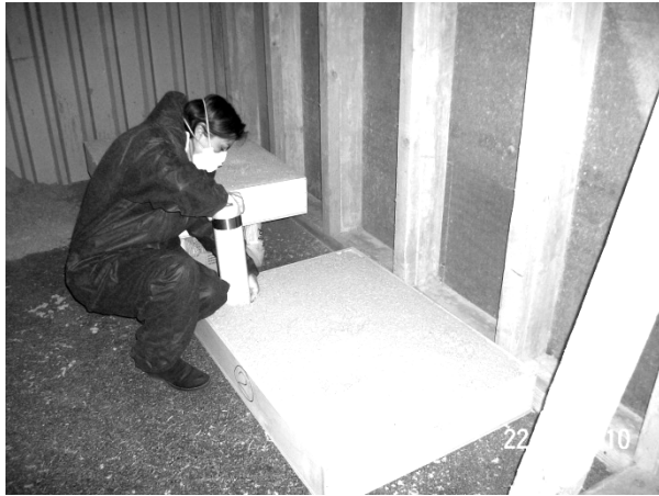
Abbildung 28: Probenahme in der Kontaktschicht mit Ausstechrohr
