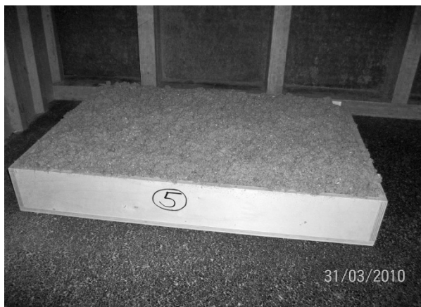
Abbildung 25: Aufblasen des Altpapierdämmstoffs im Versuchsmodell
