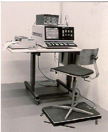
Bild 3: Einrichtung zur Messung der vertikalen dynamischen Kraft aus rhythmischem Klatschen
