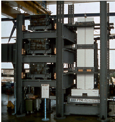
Bild 29: Anlage für dynamische Versuche mit dem ETH-Erdbebensimulator an einer 3-stöckigen Stahlbetontragwand im Maßstab 1:3
