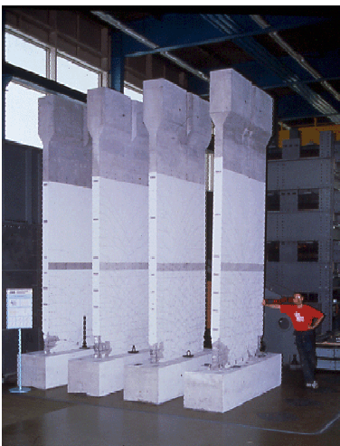
Bild 26: 4 geprüfte Stahlbetontragwände mit beträchtlichen Schädigungen im plastischen Bereich am Wandfuß
