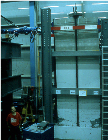
Bild 25: Anlage für statisch-zyklische Versuche an einer 6-stöckigen Stahlbetontragwand im Maßstab 1:2
