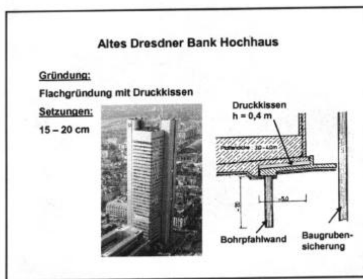
Bild 9.20: Konstruktionsdetail der Unterschneidung der Fundamentplatte des Hochhauses „Dresdner Bank“ mit Anordnung von Druckkissen [Phocas 2001, S. 88]
