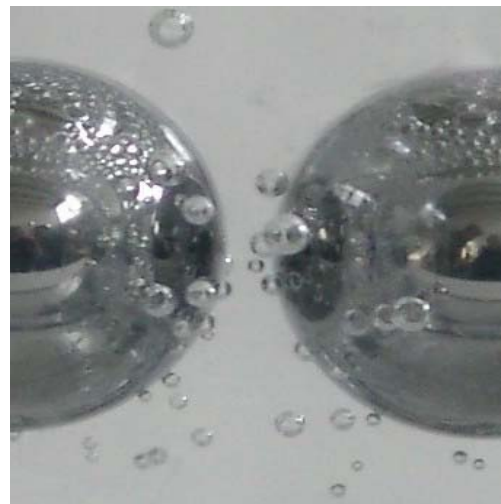
Abb. 4.2: Lufteinschlüsse in nicht entgastem Silikongel
