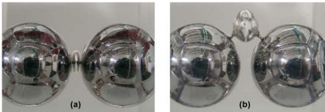
Abb. 4.11: Erscheinungsformen von Entladungskanälen im Silikongel unmittelbar nach erfolgtem elektrischen Durchschlag der Isolierstrecke
