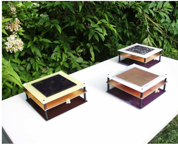
(a) Antennenmodelle mit Dünnschichtzelle, Kupferpatch sowie Polykristalliner Zelle
