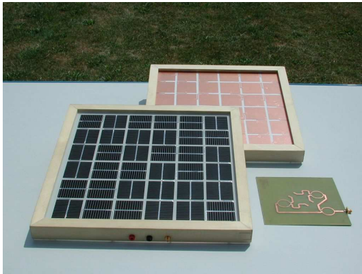
(a) Antenne mit Solarzellen (vorn) und Kupferflächen
