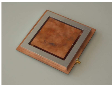
(a) Vorderseite mit Koppelpatch
