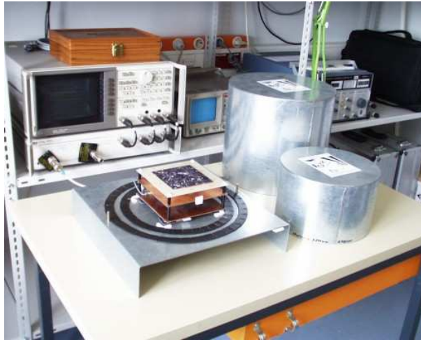
Abbildung 6.12: Wheeler-Caps in unterschiedlichen Größen für Wirkungsgradmessungen an Antennen. Der Reflexionsfaktor der Antenne mit offenem und geschlossenem Deckel wird mit einem vektoriellen Netzwerkanalysator gemessen.
