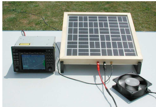
(c) PV-Antenne mit Navigationssystem und Lüfter
