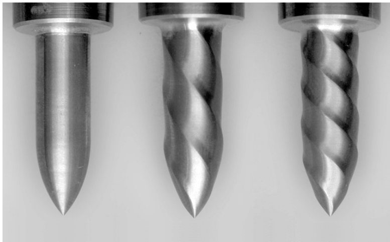
Abbildung 4-6: Fließlochformer mit wendelförmig umlaufende Formstollen
