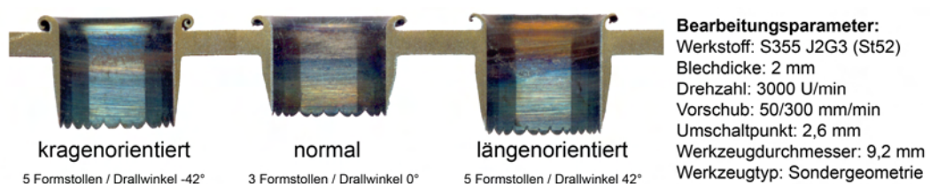
Abbildung 7-2: Einfluss von Drallwinkel und Formstollenzahl auf die Buchsengeometrie
