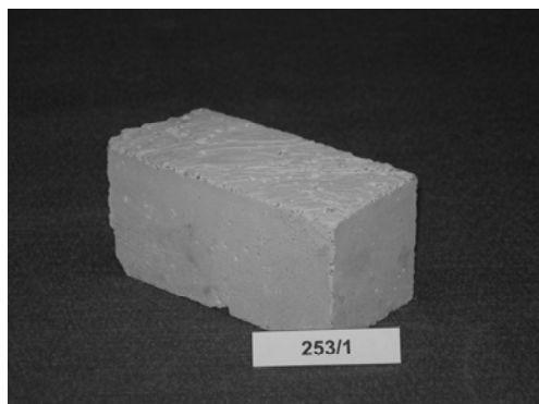
Bild A 5.12: Probe nach 50 Frost-Tau-Wechseln
