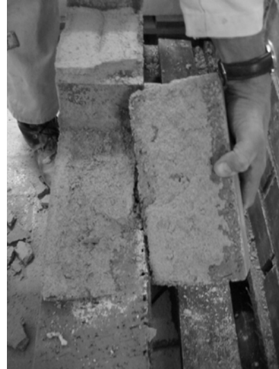
Bild 59: gute Flankenhaftung mit Methylcellulose; Probe K (20/50/30) MC
