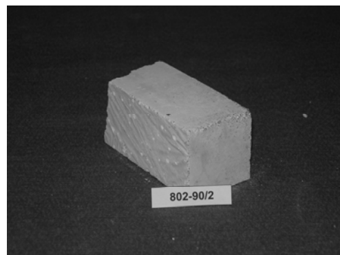
Bild A 5.13: Probe nach 50 Frost-Tau-Wechseln
