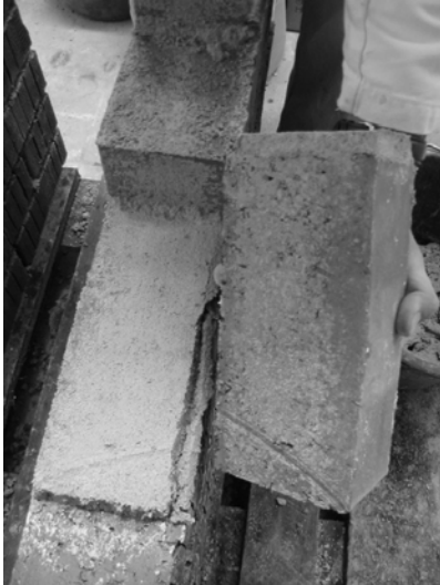
Bild 58: schlechte Flankenhaftung ohne Methylcellulose; Probe K (20/50/30)
