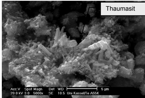
Bild A 6.1: REM-Aufnahme der Probe A55K; Lagerung bei 5/95
