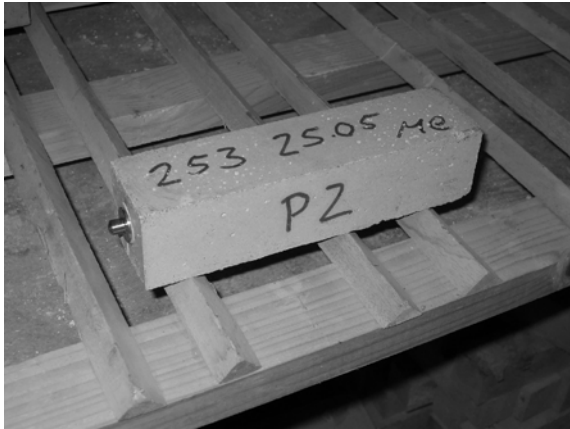
Bild 15: aufgeklebter Messzapfen vom Typ 2 (Form C)
