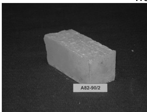
Bild A 5.14: Probe nach 50 Frost-Tau-Wechseln
