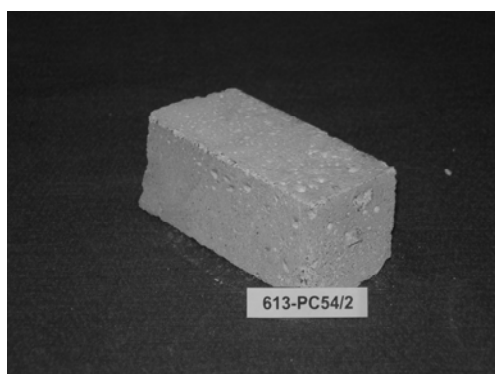
Bild A 5.15: Probe nach 50 Frost-Tau-Wechseln
