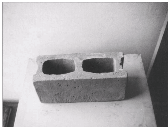
Bild 1: Hohlblockstein aus Red Mud Pozzolan Cement
