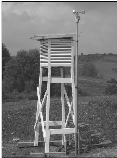
Abb. 6.1.5-1: Wetterhütte nach Wild in 2 m Höhe mit Anemometer W1 in 3 m Höhe über Geländeoberfläche.
