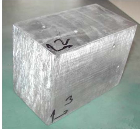
Abbildung 6.10: Inconel 182 Testblock von Serco Assurance
