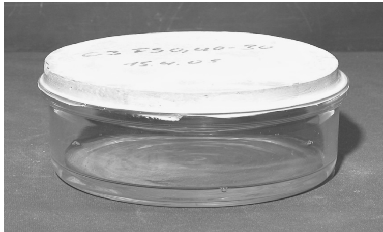
Abbildung 19: Prüfkörper nach dem Einbau auf das Prüfgefäß (Abdichtung mit Silikon).
