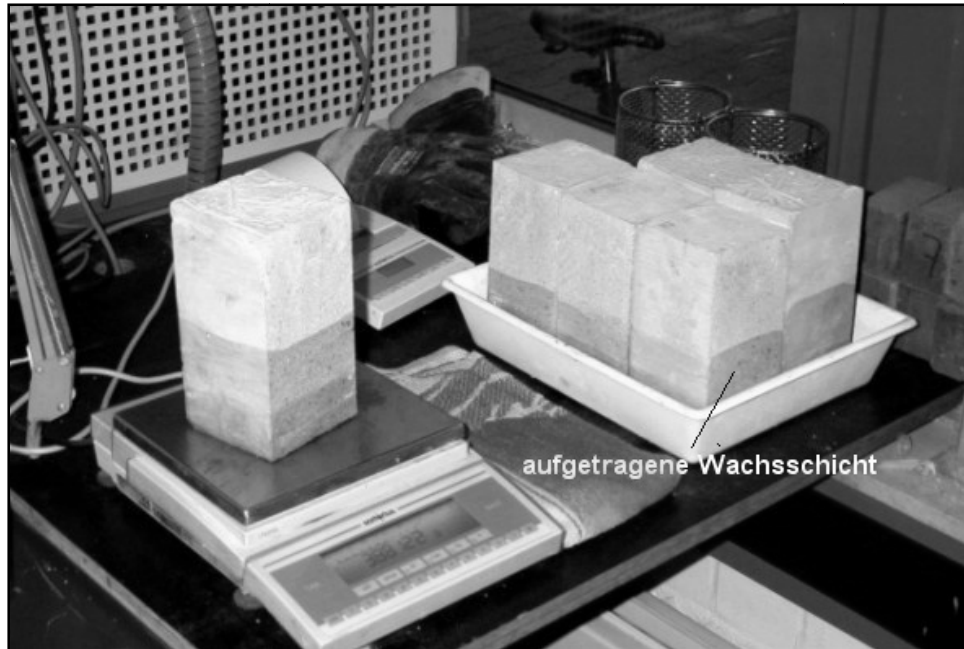
Abbildung 22: Versuchsaufbau zur Bestimmung der Wasseraufnahme durch kapillares Saugen.
