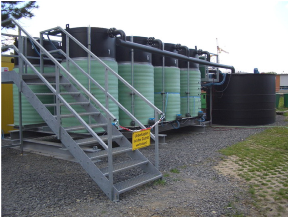
Abbildung 22: Lysimeteranlage in der Seitenansicht (Waldhoff 2008)
