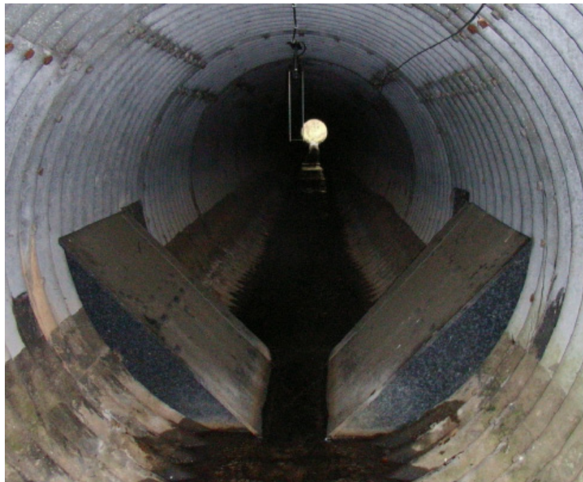
Abb. 60: Venturi-Messgerinne im Rohrdurchlass unter der Bundesstraße 83 (Pegel P1) (Schlößer, 2007)
