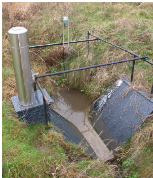
Abb. 62: Pegelstation P2 und Niederschlagsmesser N1 ca. 60 m oberstrom der Grabenmündung in den Jungfernbach (Schlößer, 2007)
