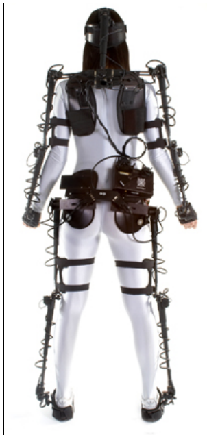
Abbildung 7: Beispiel für ein Motion-Capturing-System auf Basis eines Exoskeletts (Animazoo Gypsy-6). Aus [21].
