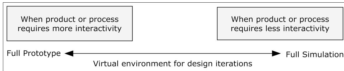
Abbildung 36: Je höher der Anteil an Interaktivität, desto sinnvoller ist die Verwendung eines physikalischen Prototyps. Nach Duffy [48].
