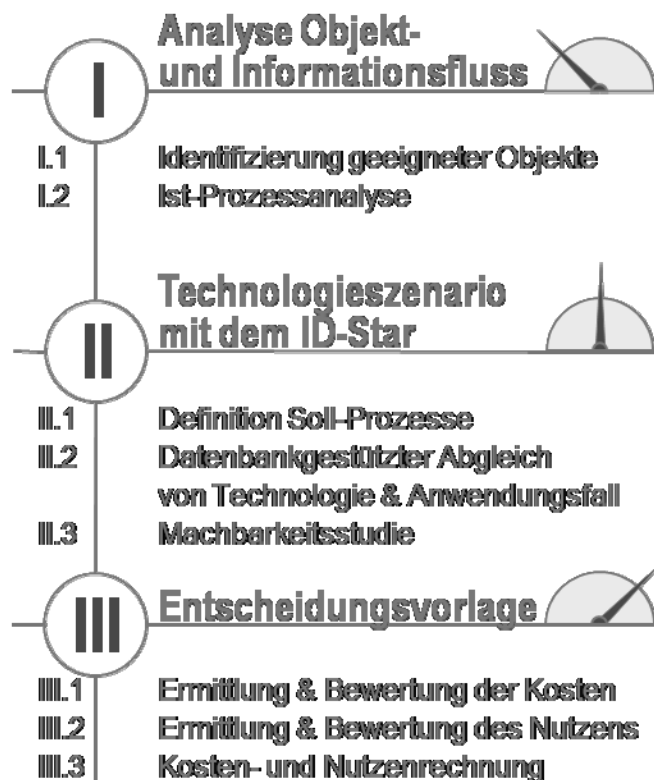
Bild 2: 3-stufiges Vorgehen zur RFID – Business Case Calculation
