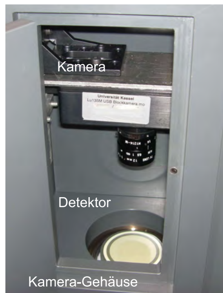
Abbildung 2.8: Foto des Multi-Channel-Plate Detektors mit Faseroptik in lichtdichtem Gehäuse mit Tür. Das verwendete Kamerasystem Lumenera Lu135 ist über USB an den Messrechner angeschlossen.
