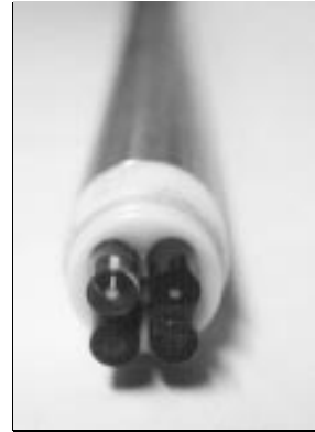
Abb. 3.1c: Detailansicht des Messkopfes mit pH-, Nitrat-, Chlorid-ISEs und dem Referenzsensor.
