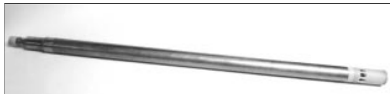
Abbildung 3.1a: Gesamtansicht der ISE-Loggingsonde, Länge 1150 mm, Durchmesser 41 mm.
