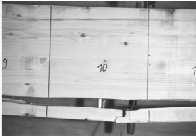
Abbildung 7.17: Versagen der Keilzinkung in der äußeren Lamelle bei 29,7 kN
