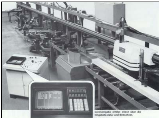
Bild 1.3: Die erste Abbundanlage (Firma Burmek 1984) 5
