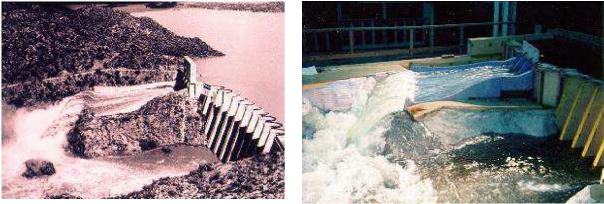
Abb. 6.2: Wehrüberlauf des Barlett-Staudammes (USA) (links), mit Labormodel (rechts)
